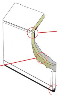
Coupe-froid et joint horizontal procurant une étanchéité parfaite. Aucune circulation d'air entre les panneaux.
